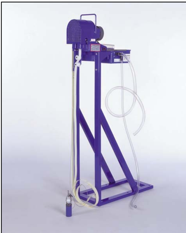
PetroXtractor mit Standgestell und Ölkonzentrator
